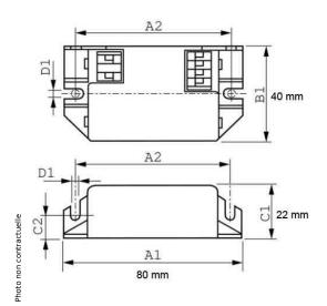
Ballast électronique pour T5=1x13/14/15w DE=1x10/13w TE=1x13w SE=11w 230V Philips
