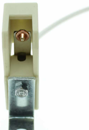
Douille R7S 78mm 6A 250v 350°C Equerre Acier avec câble 25cm SQ70
