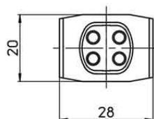
**Douille G10Q 4 Fils pour Circline et Tube 4 Pins
