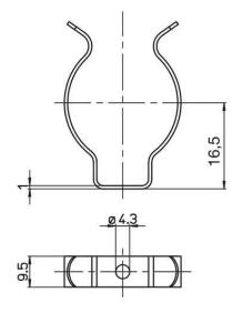
Clip Chromé de fixation pour Tube ou Circline Diamètre 26mm /32mm 37SVD Stucchi
