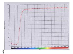
Gaine White C20 T8 Inactinique 395nm pour tube 600mm (sans tube)
