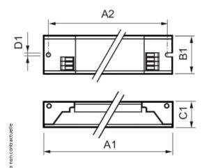
Ballast electronique HF-P 249 TL5 HO III 220-240V 50/60Hz IDC
