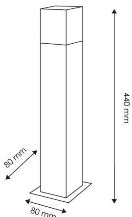
Borne Douille E27 max 40w Hauteur 440mm sans lampe
